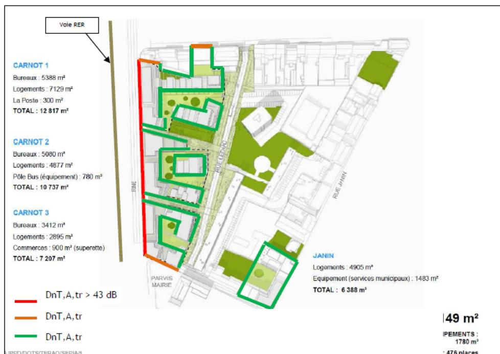
Figure 32 : Objectifs d'isolement des façades pour l'îlot Carnot
